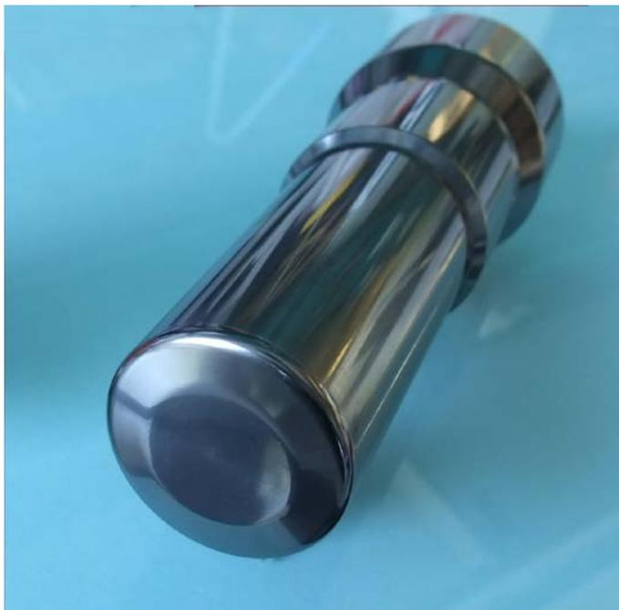
Formwerkzeug, beschichtet mit 10 µm AlCrSiN/TiN-Nanocompositschicht
